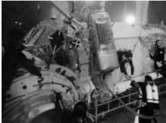
Basen o pławności neutralnej służący do treningu kosmonautów Neutral buoyancy facilities used to train astronauts
